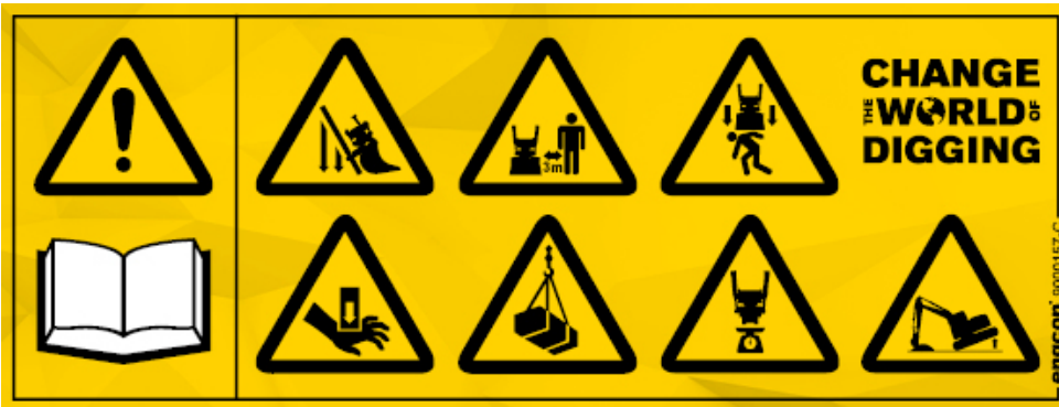
Afbeelding26. Waarschuwingsticker aan rechterzijde van de machinist.
